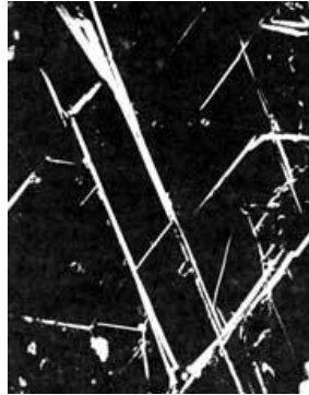
Figura 19. Micrografía de un cristal de grafito en la que se observan canales debidos a la oxidación a alta temperatura. Estos canales son el camino de las partículas metálicas que se mueven. La imagen se obtuvo en un microscopio (X250).
